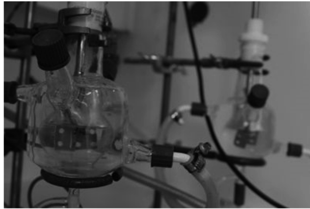
Abbildung 4-5 - Aufbau des Aktivitätstests mit beschichteten Packungsstücken. Die Packungsstücke werden direkt an einer Rührwelle befestigt und im Reaktionsgemisch in einem temperierbaren Glasreaktor bei 50 rpm gerührt.
