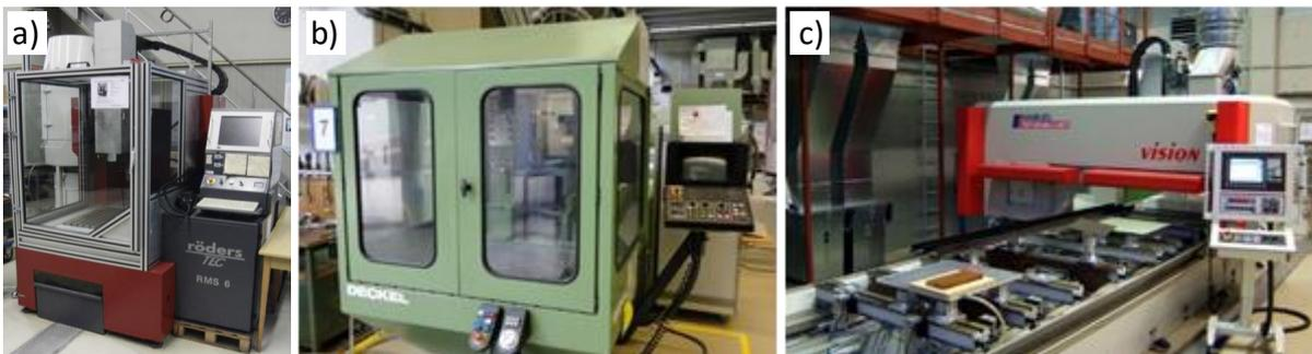
Abbildung 6.1: Versuchsmaschinen zum Hobeln und Fräsen von CFK a) Rödgers, b) Deckel, c) Reichenbacher
