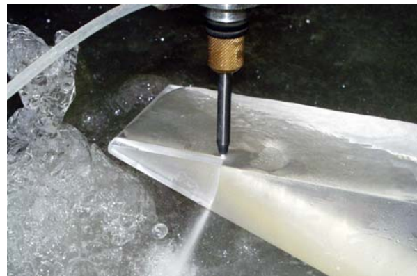
Abbildung 10-25: ADWS-Schnittversuch an einem Plexiglaskeil.
