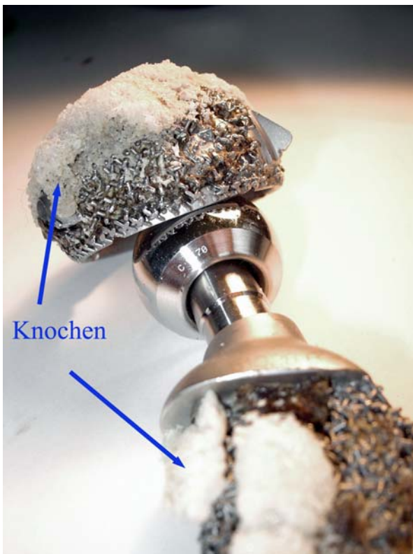
Abbildung 1-2: Bei der Revision entfernte Hüftendoprothese.
