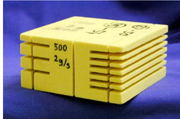
Abbildung 13-5: Schaumprobe zur Simulation der intertrabekulären Hohlräume.
