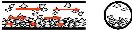
Abbildung 19-21: Schematische Darstellung der Strähnenförderung
