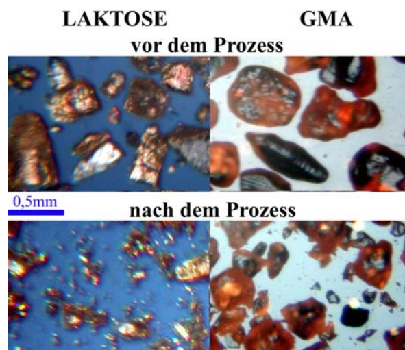
Abbildung 10-26: Lichtmikroskopie der Abrasivpartikel vor und nach dem Schneiden.
