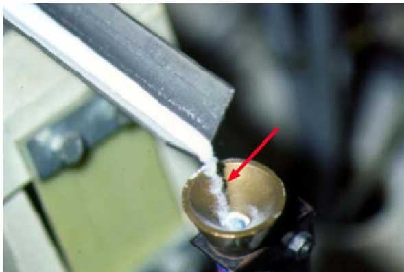
Abbildung 6-10: Oszillierende Rinne zur Abrasivmitteldosierung.
