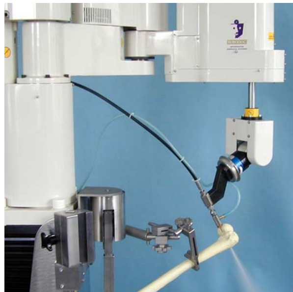
Abbildung 15-1: Operationsroboter mit einem ADWS-Strahlkopf.
