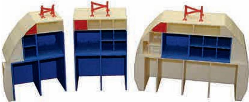
Bild 6-18: FDM-Druck von Demonstratoren des entwickelten Konzeptes; Übernahmekomponenten (Blau), anpassbare Komponenten (Rot), spezifische Komponenten (Weiß); Galley G2, G3, G5 (v.l.)
