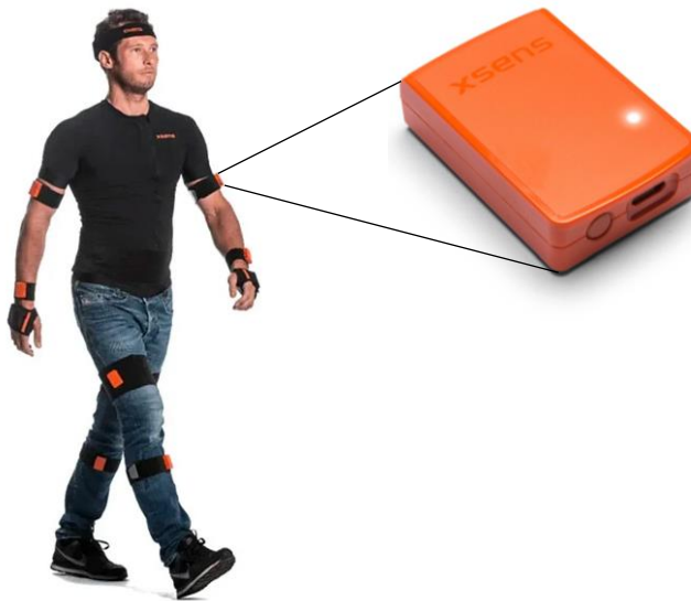
Abbildung 2-11: Das Motion-Capture-System XSens MVN Awinda [XSEN22] mit 17 wireless Motion Trackern (MTw) [PAUL18, S. 2]
