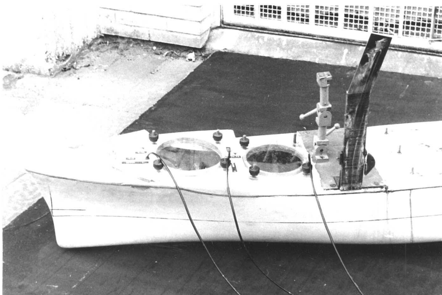
Modell für Dreh-Fall- versuch ausgerüstet
