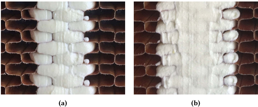
Abb. 4.14.: Vergleich der oberflächlichen Befüllergebnisse bei (a) flexibler und (b) starrer Düse
