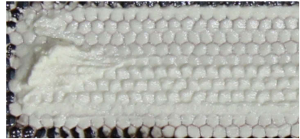
Abb. 4.23.: Exemplarisches Befüllergebnis bei Regelung des Dosierdrucks mit D_D = 15 mm, h_K = 9,8 mm und Q_{ab} \leq 171 ml min -1 ; (a) Druckverlauf, (b) Oberseite, (c) Unterseite
