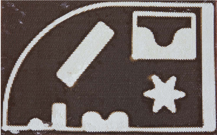
Abb. 4.43.: Unterseite des Testbauteils nach Entfernen der unteren Decklage zur Validierung der vollständigen Befüllung ohne Lufteinschlüsse
