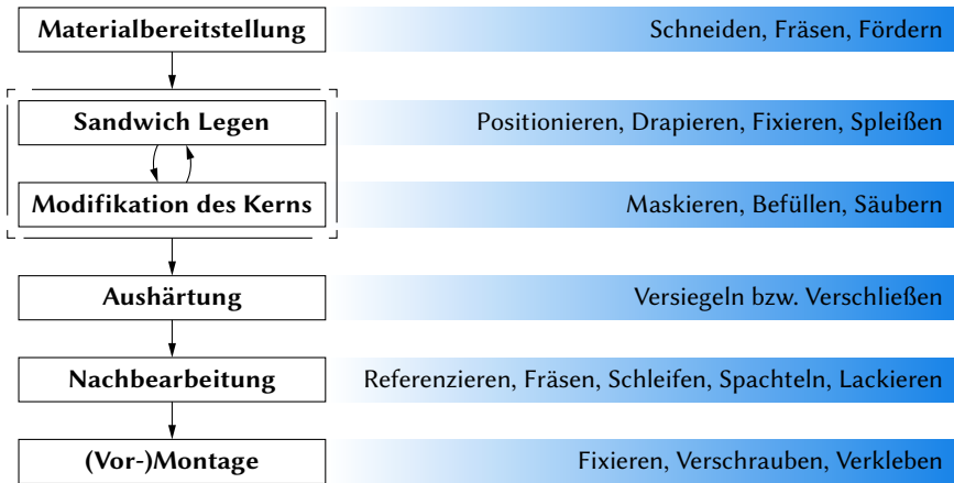
Abb. 2.11.: Übersicht über die allgemeine Prozesskette zur Fertigung von Sandwichpaneelen sowie exemplarischer Tätigkeiten
