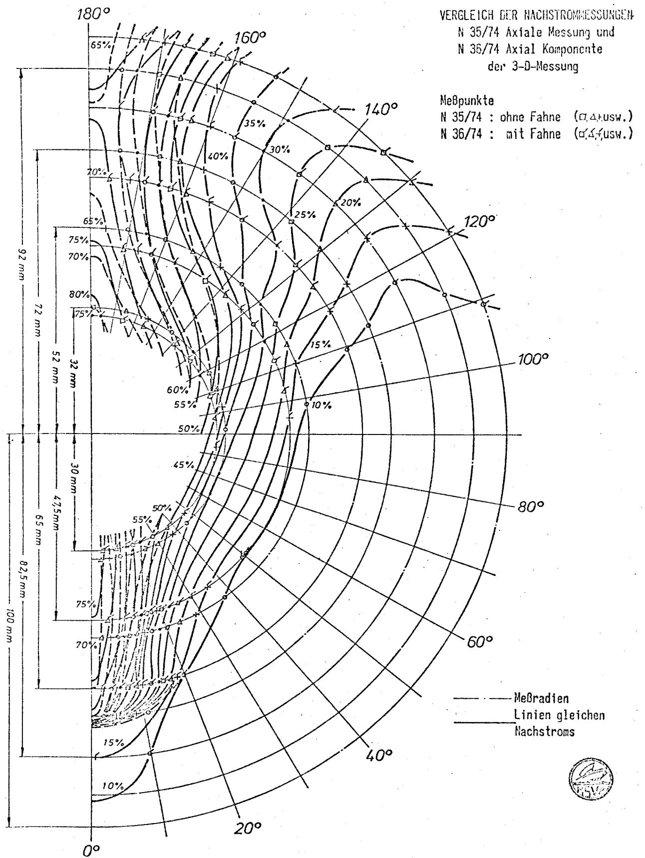
Abb. 9 Vergleich der Nachstommessungen (1-dim. und 3-dim.)
