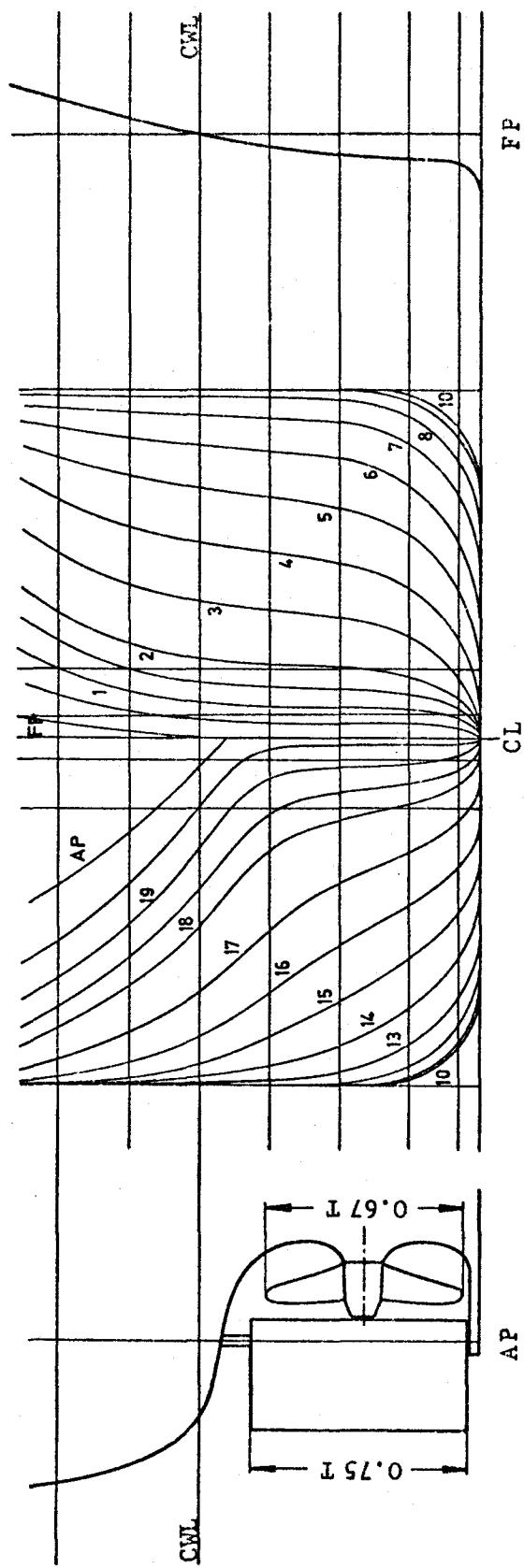
Abb. 2 Spantenriß des HSVA-Modells Nr. 1512 einschl. Seitenansicht
