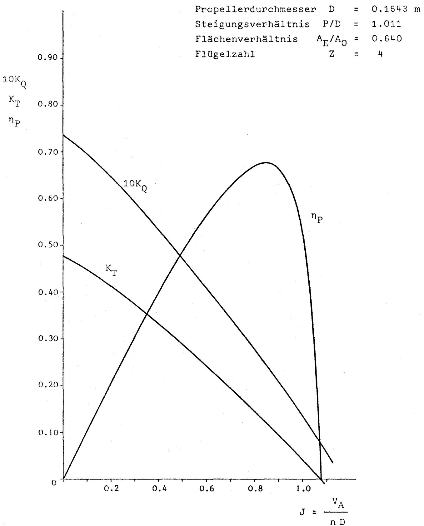
Abb. 3 Freifahrtdiagramm HSVA-Propeller Nr. 764
