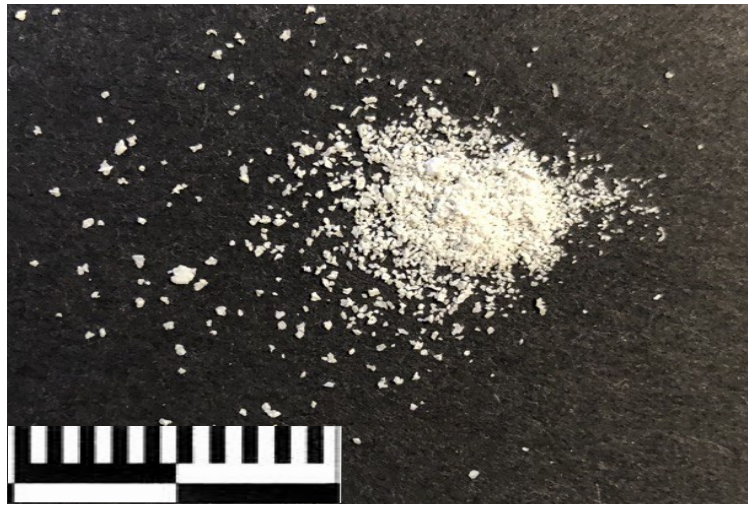
Abbildung 2.10: Knochenpartikel hergestellt aus einer mazerierten Spongiosaprobe aus dem Femur eines Schweins zerkleinert mit einer Formraspel (DePuy Orthopaedic, 2001) der Raspeltiefe 0,5 mm
