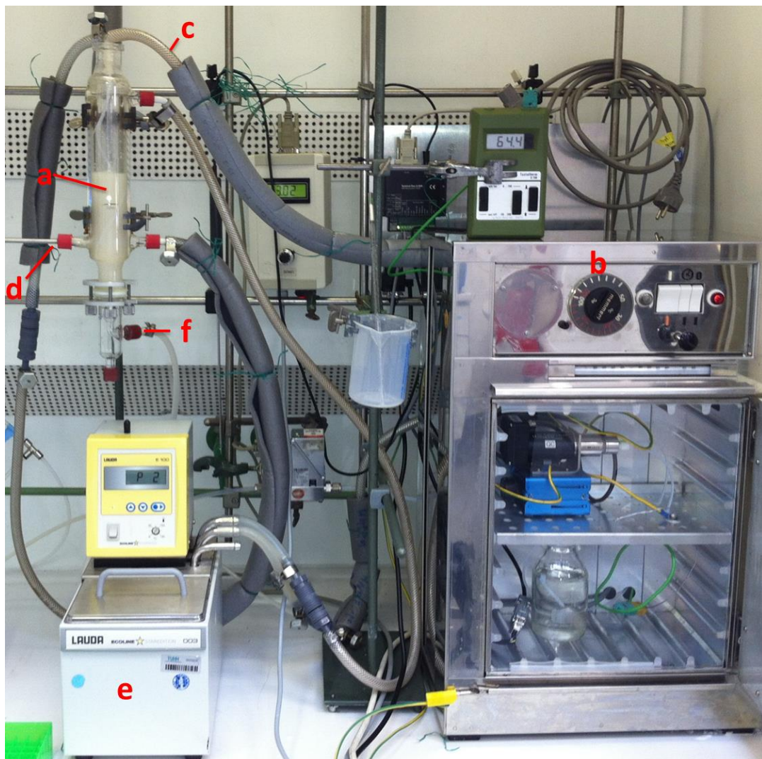
Abbildung 4.24: Versuchsaufbau für einen Fed-Batch-Versuch: a) Blasensäulenreaktor b) Heizschrank c) Doppelmantelheizschlauch für den Laurinsäurezulauf d) FTIR-ATR-Sonde e) Wasserbad f) Druckluftbegasung
