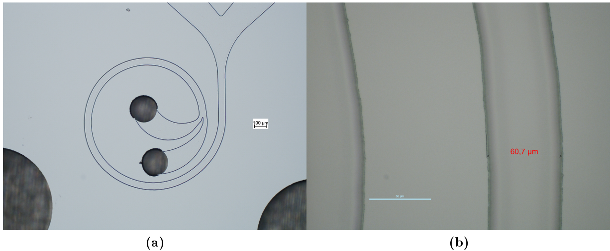
Abbildung 10: Spiralstruktur nach dem Ätzen und Bonden (zur Verfügung gestellt von Sven Bohne, Institut für Mikrosystemtechnik der TUHH)
