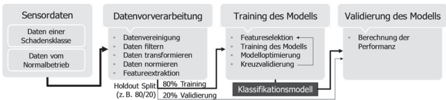
Bild 7: Prozess zum Trainieren eines Klassifikationsmodells
