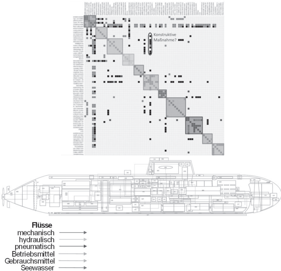
Abbildung 5: Partialmodelle Design Structure Matrix (DSM, oben) und Module Interface Graph (MIG, unten) auf Basis des Metamodells
