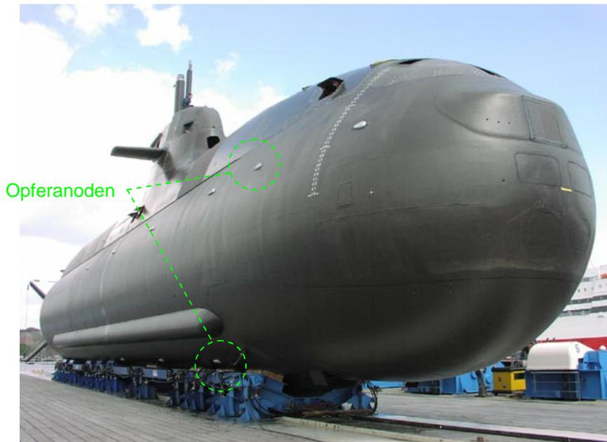
Abbildung 29 - Opferanoden am Uboot [F1]
