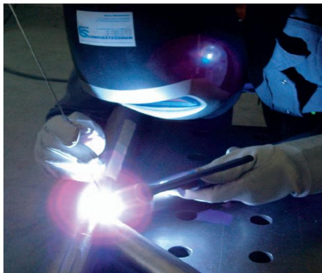
Abbildung 37 - TIG - Schweißen von Ti2 [P13, S.6]
