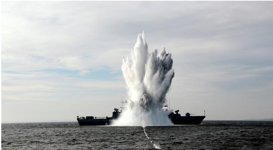
Abbildung 15 - Ansprennung einer Korvette [F4]
