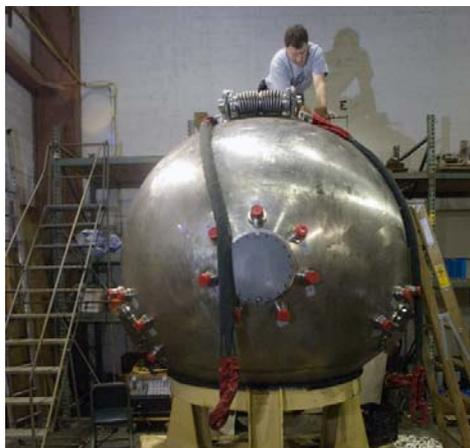
Abbildung 38 - Druckkörper Forschungstauchboot ALVIN [I6]
