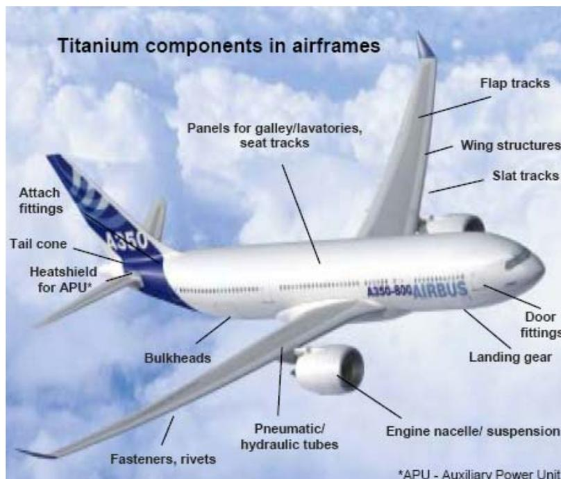
Abbildung 11 - Titanelemente im Airbus A350 [P2, S.6]
