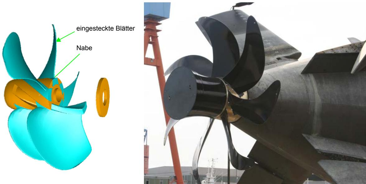
Abbildung 23 - Befestigung der Propellerblätter [F1]
