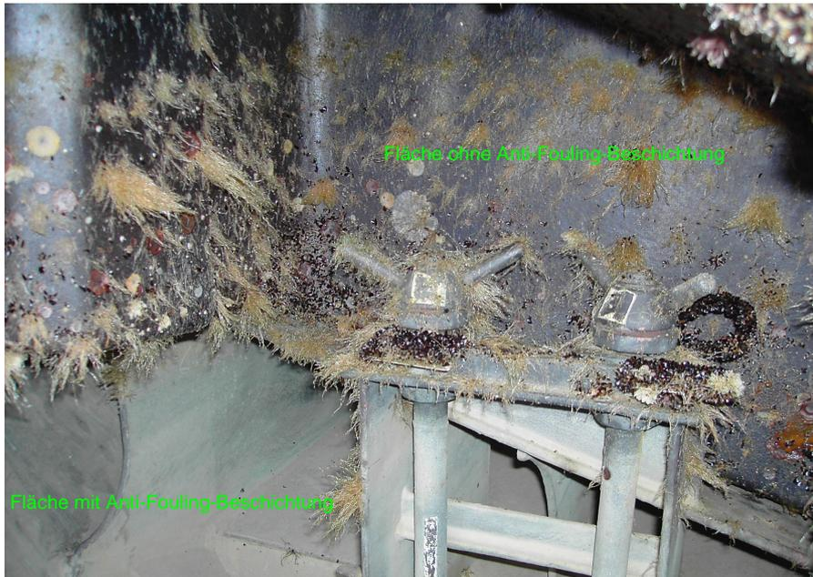
Abbildung 25 - Bewuchs an Schiffskomponenten [F1]
