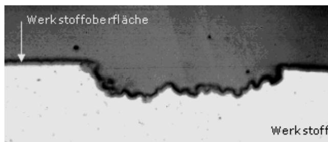
Abbildung 19 - Muldenkorrosion [12]
