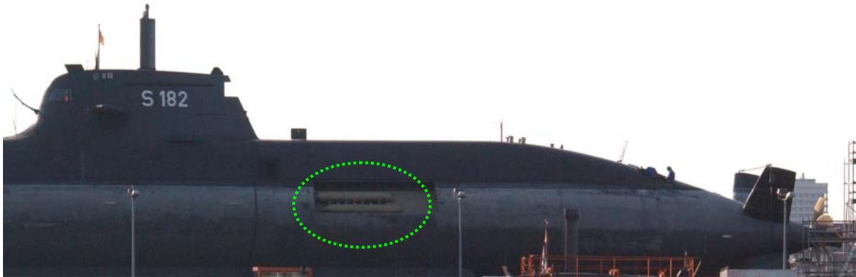
Abbildung 45 - gedocktes Uboot mit sichtbaren Metallhydridspeichern [F1]
