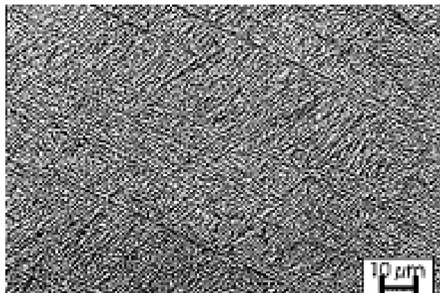
Abbildung 6 - martensitisches Gefüge von TiAl6V4 [P1, S.15]
