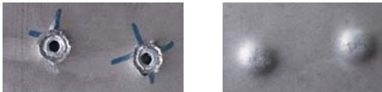
Abbildung 34 - Beschusstest von 1.3964-Platten, links: Vorderseite, rechts: Hinterseite [F1]
