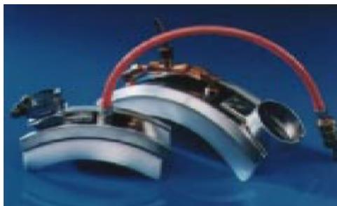
Abbildung 38 - Schutzgasschiene [P11, S.19]
