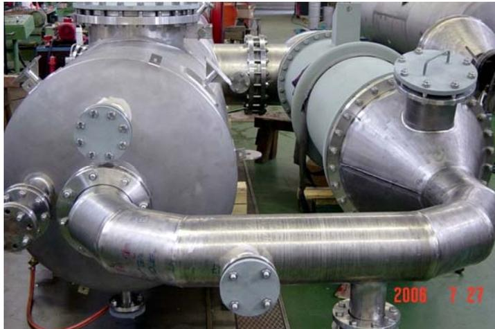
Abbildung 49 - Rohrbündelwärmetauscher [ASE-Apparatebau GmbH]
