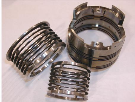
Abbildung 34 - Erodieren von Titan [www.alltec-precision.com, 15.06.2010]
