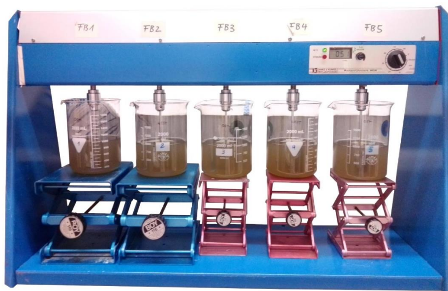
Abbildung 4-1: Jartest zur Durchführung von parallelen Fällungs-/Flockungsversuchen
