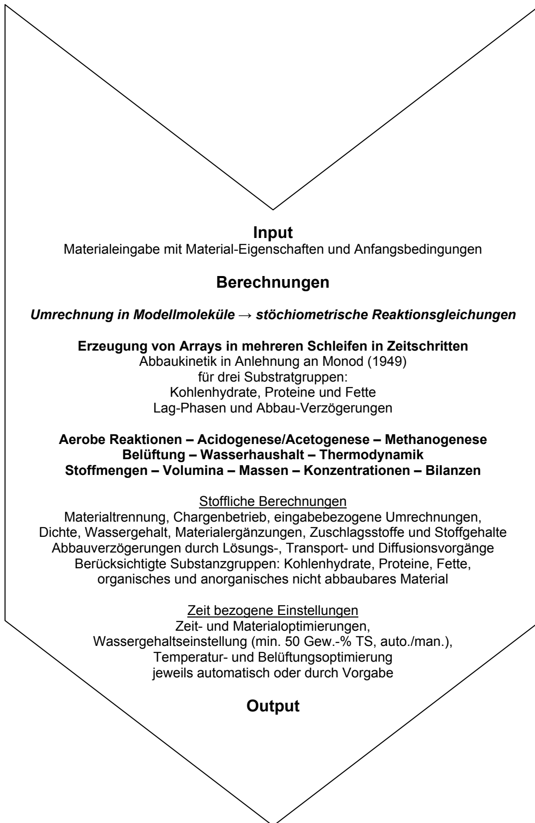
Abb. 3-2: Übersichtsdarstellung des Simulationsmodells (Datenverarbeitung) zur Entwicklung einer Software für die Prozesssimulation aerober und anaerober Abbauprozesse im Bereich der Abfallwirtschaft
