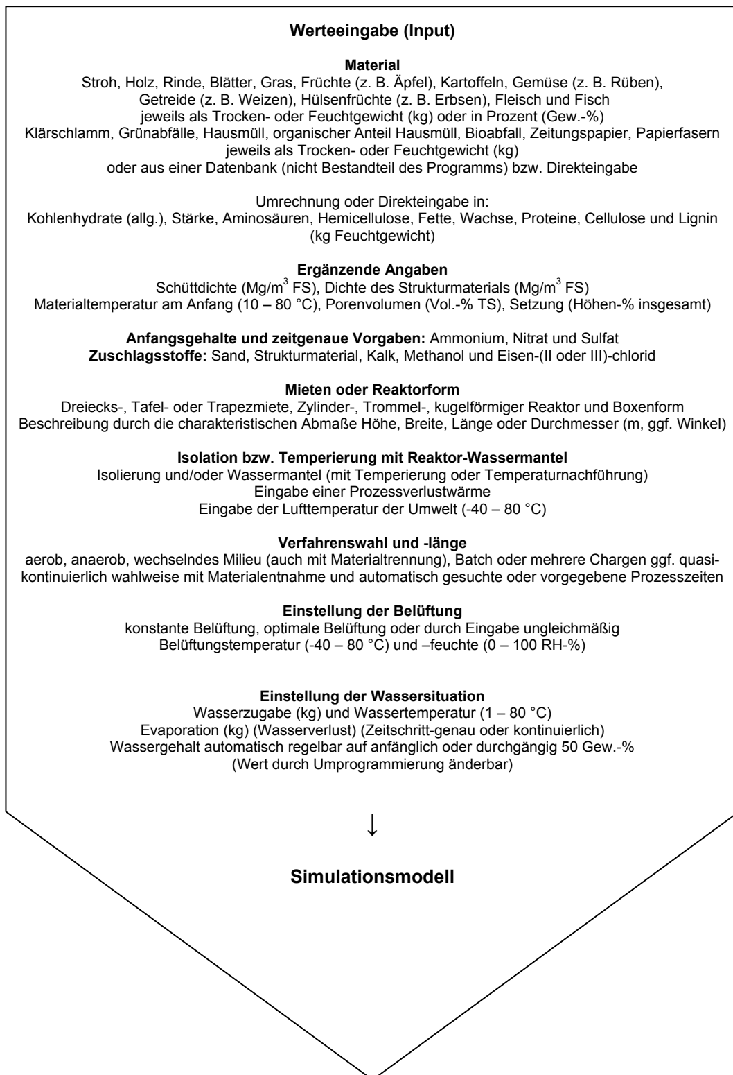
Abb. 3-1: Übersichtsdarstellung der Eingabewerte (Input) des Simulationsmodells aerober und anaerober Abbauprozesse im Bereich der Abfallwirtschaft
